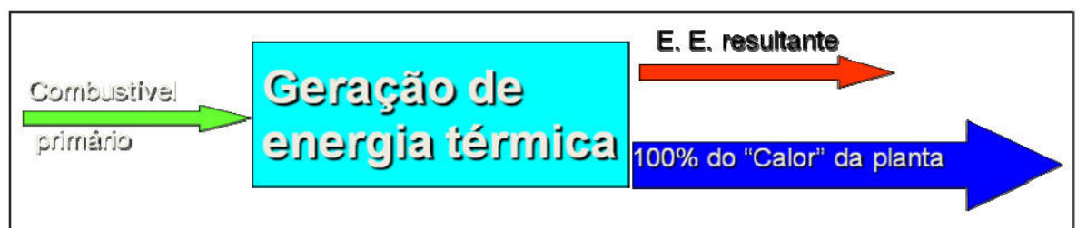
Figura 7 Esquema de cogeração conforme regime Bottoming. Fonte: ANDREOS, 2014
