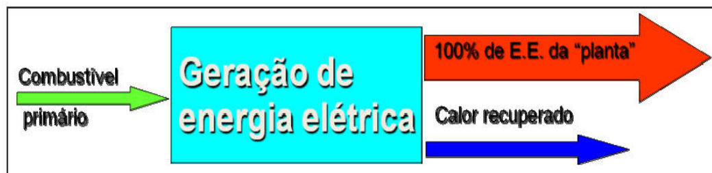
Figura 8 Esquema de cogeração conforme regime Topping. Fonte: ANDREOS, 2014
